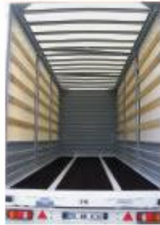
İç Taban : İsteğe göre tabanda tahta profil, profil üstü düz veya baklava sac, Wisa taban kontraplak
